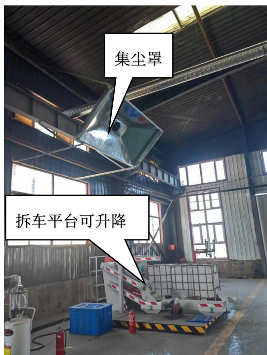
集气罩收集车身、车架切割（火焰切割）产生的颗粒物
