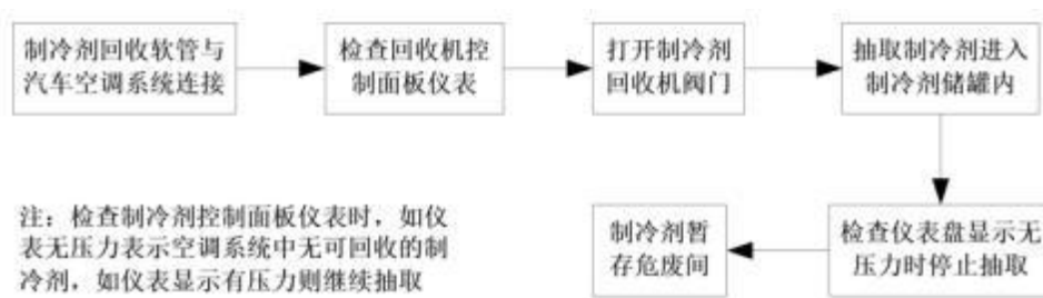
图 3-4 空调制冷剂收集工艺流程
